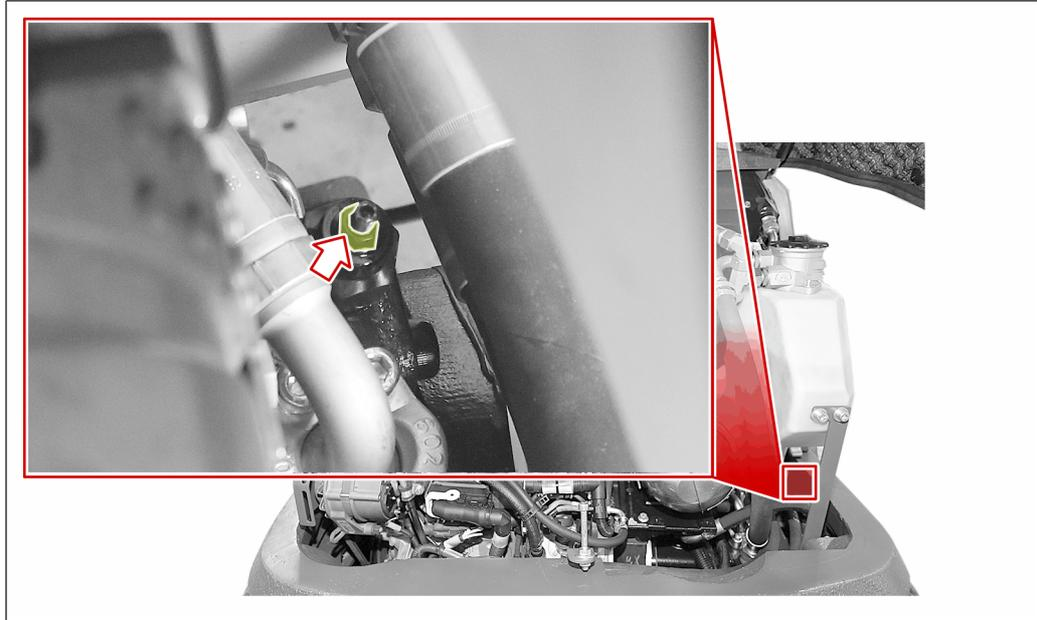
↳ Die Anschlagsschraube ist gegen Lösen gesichert.
