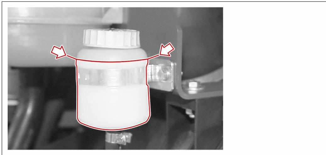
? *Der Füllstand ist unter der Maximumlinie?*
