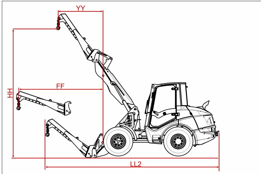
Maßzeichnung AX 850 mit montiertem Anbaugerät
