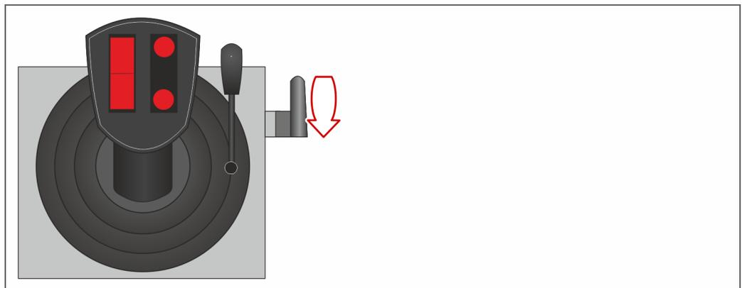
↪ Die Arbeitshydraulik des Radladers ist verriegelt.
