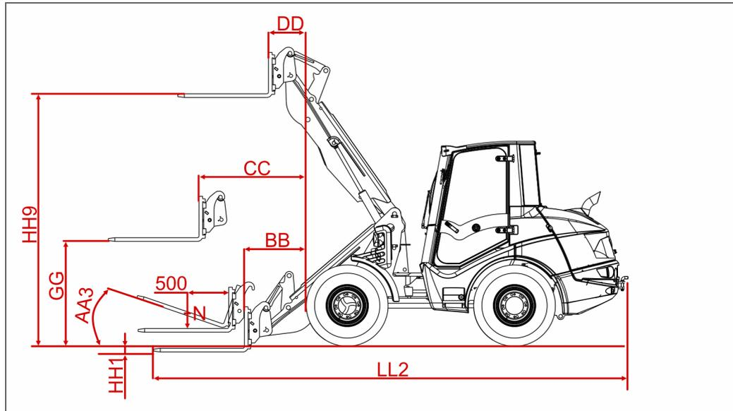
Maßzeichnung AX 850 mit montiertem Anbaugerät
