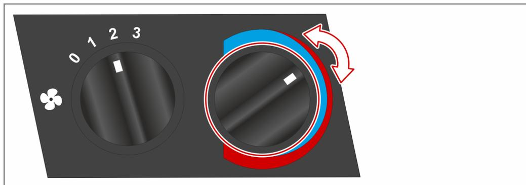
**!** Warme und kalte Luft wird entsprechend der gewählten Stellung des Drehreglers miteinander vermischt und strömt aus den Lüftungsauslässen.
