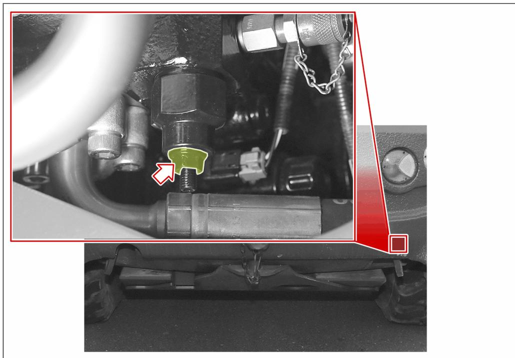
→ Die Anschlagschraube ist gegen Lösen gesichert.
