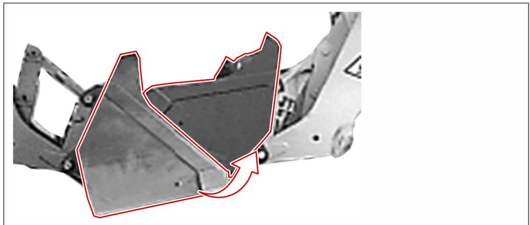
4. Montieren Sie die **«SCHAUFELARMSTÜTZE»**.
