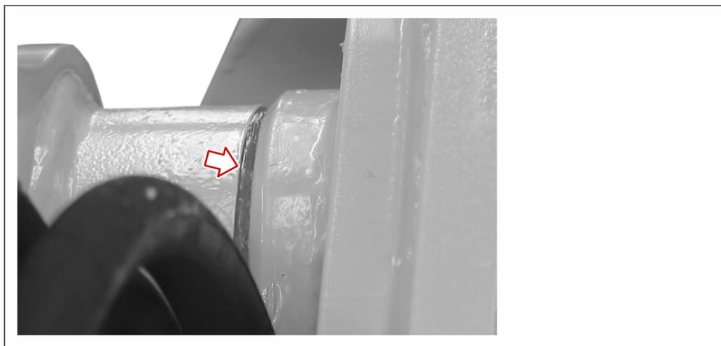
Der Schmiervorgang ist durchgeführt.
