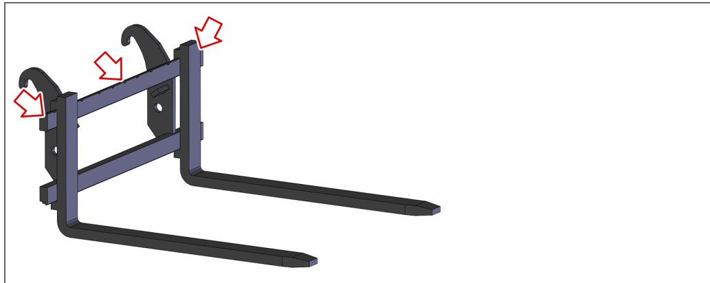
Übersicht – Schmierstelle am oberen Träger
