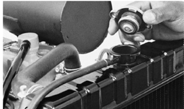
Contrôle du niveau de liquide de refroidissement dans le radiateur
