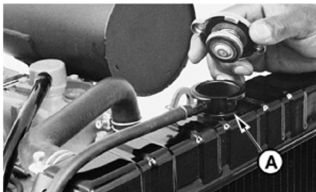
Goulotte de remplissage du radiateur
