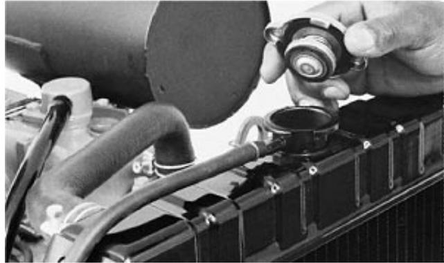
Vérification du niveau de liquide de refroidissement dans le radiateur
