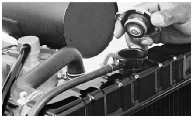
Bouchon de remplissage du circuit de refroidissement
