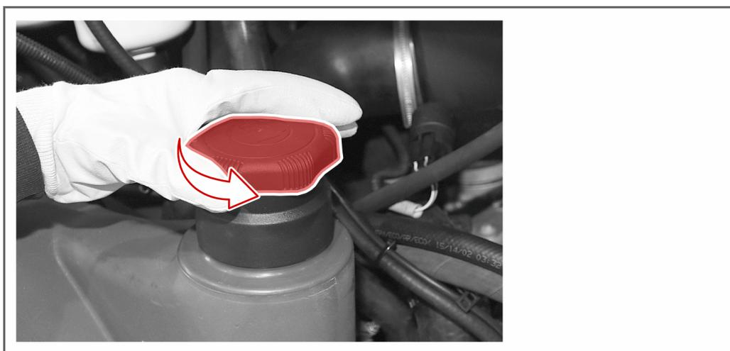
3. Füllen Sie vorsichtig «DIESELKRAFTSTOFF» in den «TANK».
