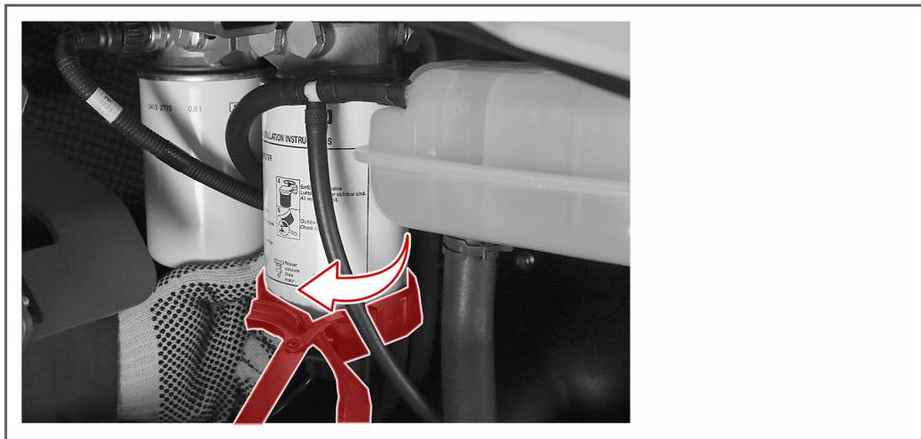
4. Drehen Sie den Kraftstoffvorfilter vorsichtig von der Halterung ab.
