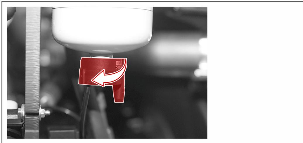
6. Befestigen Sie das Wasserabscheiderventil am neuen Kraftstoffvorfilter.
