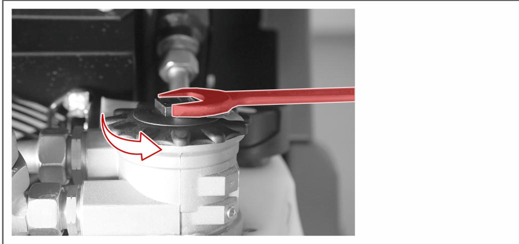
3. Drehen Sie den Deckel mit der Hand ab.
