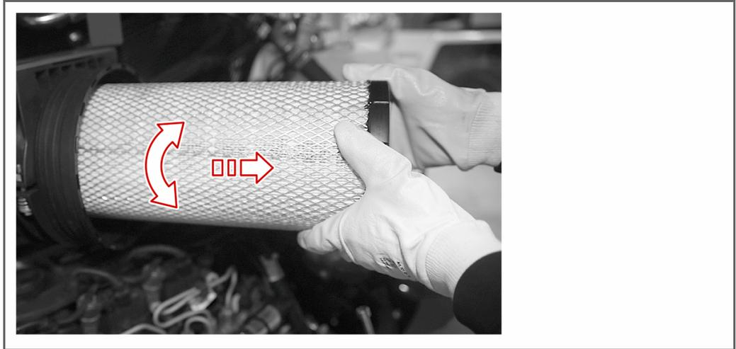
Die Luftfilterpatrone wurde demontiert.
