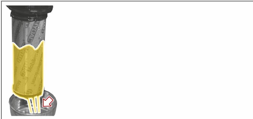
**6.** Legen Sie den Hydrauliköl-Filter in den Öl-Auffangbehälter.
