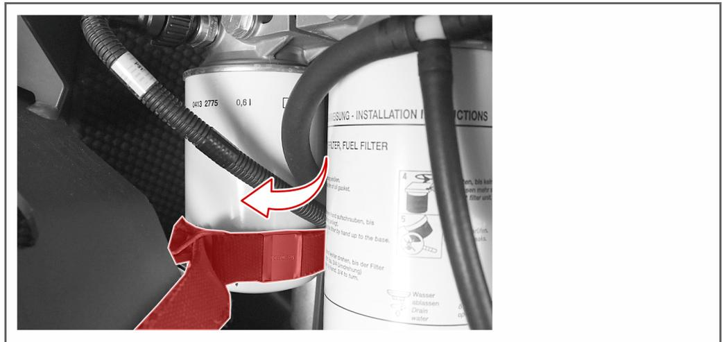
3. Drehen Sie den Kraftstoffvorfilter vorsichtig von der Halterung ab.
