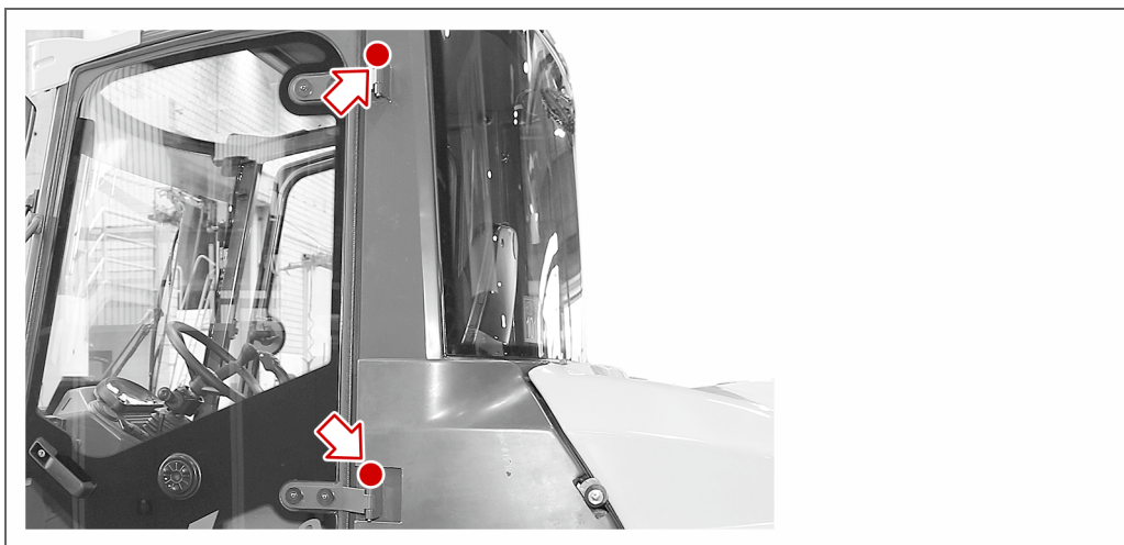
Porte | respectivement 2 points de graissage (des deux côtés)
