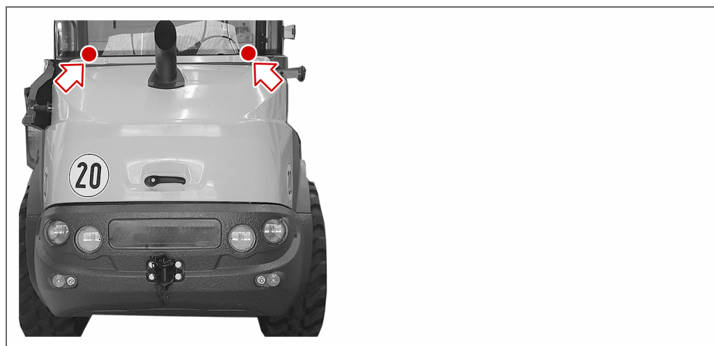
Capot moteur | 2 points de graissage
