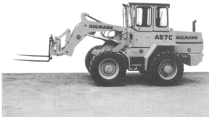
fig. 7: Chargeur à bras pivotant avec fourches élévatrices
