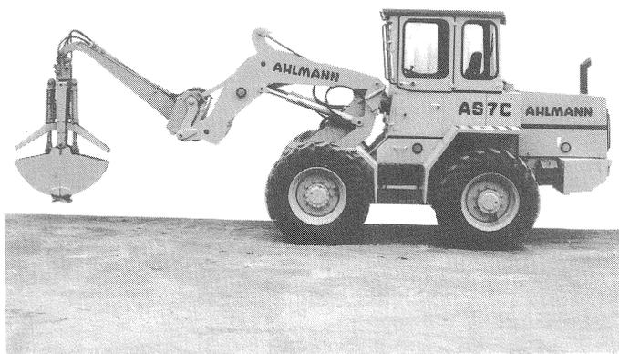
fig. 4: Chargeur à bras pivotant avec benne preneuse
