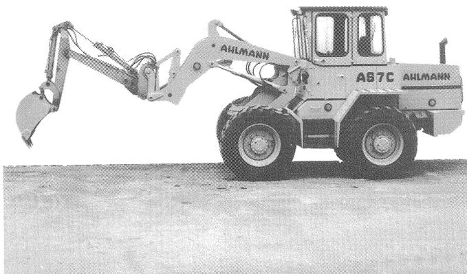
fig. 5: Chargeur à bras pivotant
