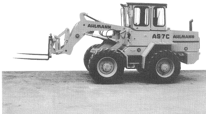
fig. 7: Chargeur à bras pivotant avec fourches élévatrices
