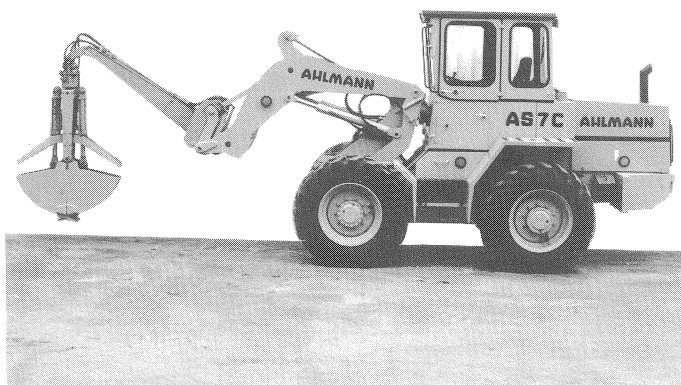
fig. 4: Chargeur à bras pivotant avec benne preneuse
