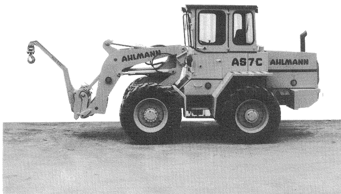
fig. 6: Chargeur à bras pivotant avec crochet de grue
