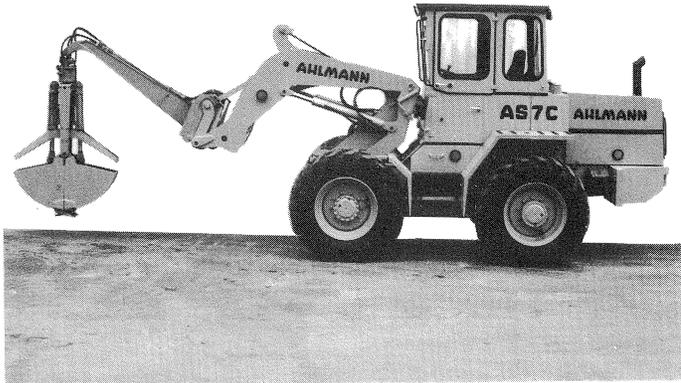
Bild 4 Schwenklader mit Greifer
