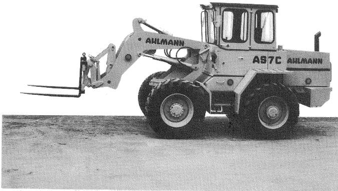
Bild 7 Schwenklader mit Hubgabel
