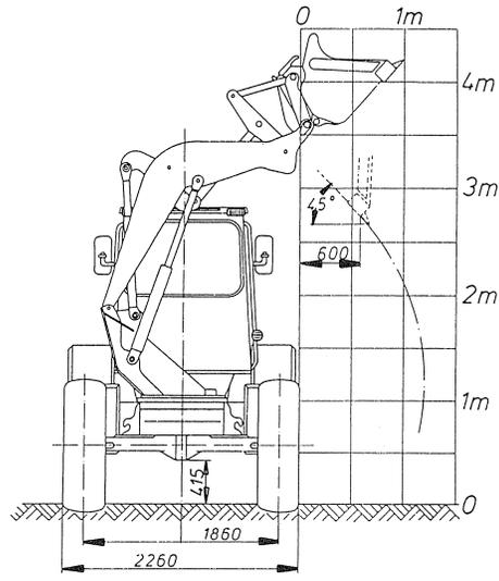
Reichweitendiagramm mit 1,0 m<sup>3</sup> Schaufel
