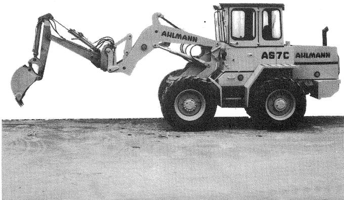
Bild 5 Schwenklader mit Tieflöffel
