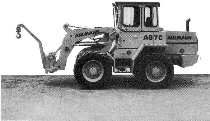
Bild 6 Schwenklader mit Lasthaken
