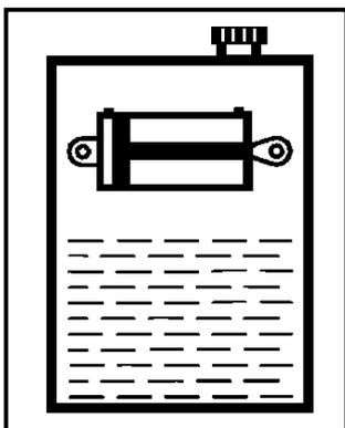
Réservoir d'huile hydraulique
