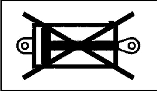
Vanne de blocage à boisseau sphérique en position fermée pour l'hydraulique de travail et l'hydraulique accessoire
