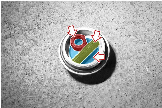
2. Schrauben Sie die «INNENSECHSKANTSCHRAUBE» und die «UNTERLEGSCHIEBE» in das Gewinde des Federspeichers hinein.
