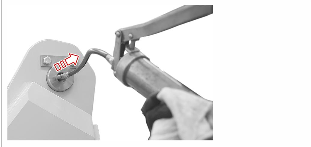
2. Reinigen Sie den **«SCHMIERNIPPEL»** mit dem **«LAPPEN»**.
