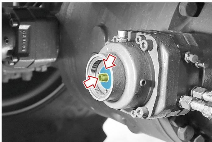
3. Drehen Sie die Mutter auf die montierte Innensechskantschraube
