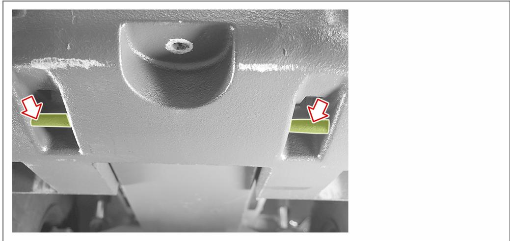
Anschlagpunkte – hinten zum Verzurren des Radladers für den Transport auf einem Anhänger
