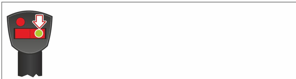
↳ Der Radlader wird bei Stillstand nach **vier Sekunden** in die gewünschte Getriebestufe umgeschaltet.
