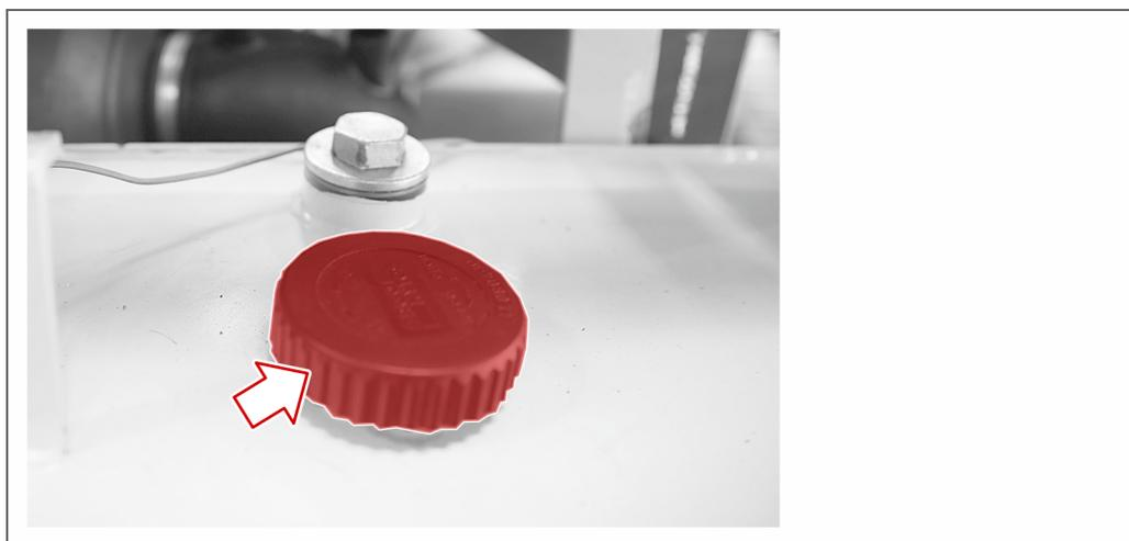
5. Füllen Sie mit einem geeigneten **«TRICHTER»** das **«HYDRAULIKÖL»** in den geöffneten **«HYDRAULIKÖL-EINFÜLLSTUTZEN»**.
