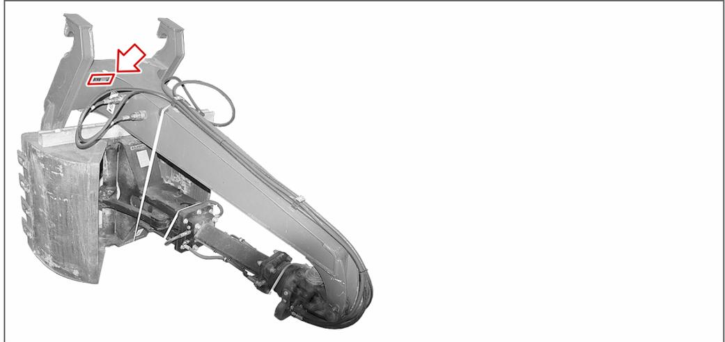
Lage des Typenschildes am Anbaugerät (Rückseite)
