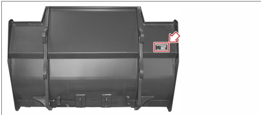
Lage des Typenschildes am Anbaugerät (Rückseite)
