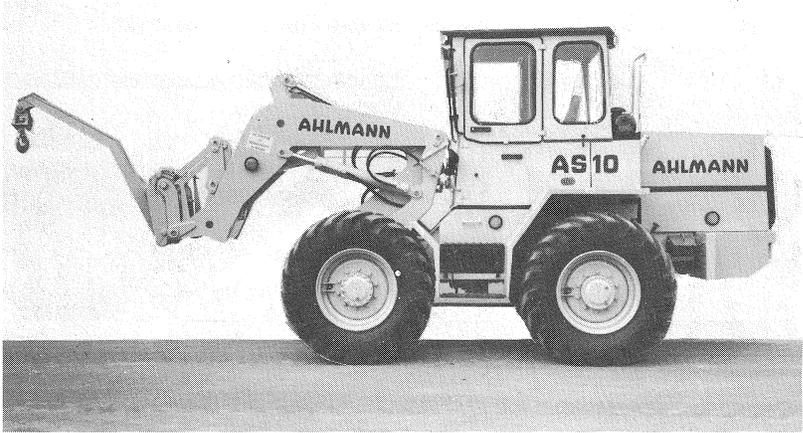
Bild 6 Schwenklader mit Lasthaken
