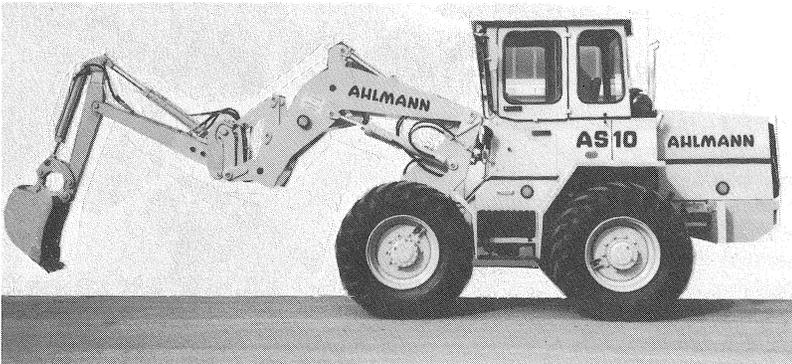
Bild 5 Schwenklader mit Frontbagger
