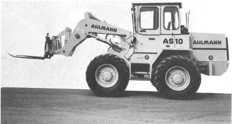
Bild 7 Schwenklader mit Hubgabel
