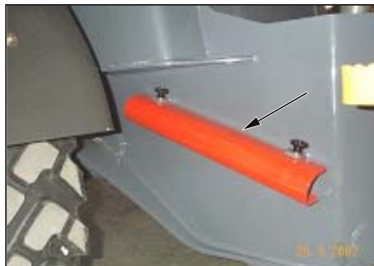
Barre de blocage à l'arrêt
