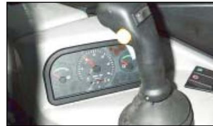
Le compteur horaire permet de déterminer le moment où il faut effectuer les opérations d'entretien. Quand le moteur thermique est en marche, il marque l'heure comme une simple horloge.
