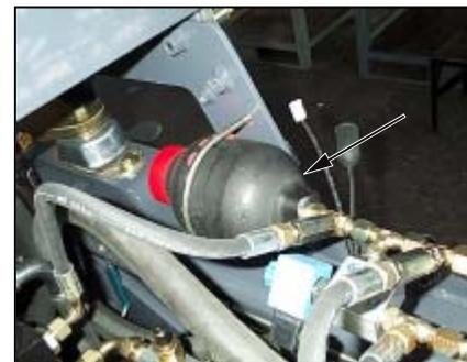
Un accumulateur d'énergie est installé dans le système de freinage, pour garantir un certain nombre de freinages même lorsque le moteur est arrêté.
