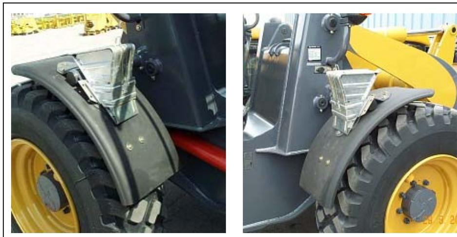
Les cales pour les roues sont logées dans les deux supports situés sur les ailes avant de l'engin.
