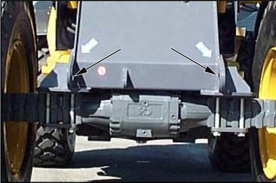
S'il s'avère nécessaire de remorquer la machine à la suite d'une défaillance des composants, procurez-vous une barre fixe assez solide pour supporter le poids de la machine et fixez-la au crochet qui se trouve sur la partie avant de la machine. (voir photo).
