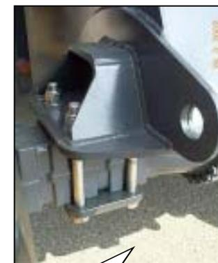
Schrauben durch Schraubenkopf spannen: 784±30 Nm (80±3 Kgm)
