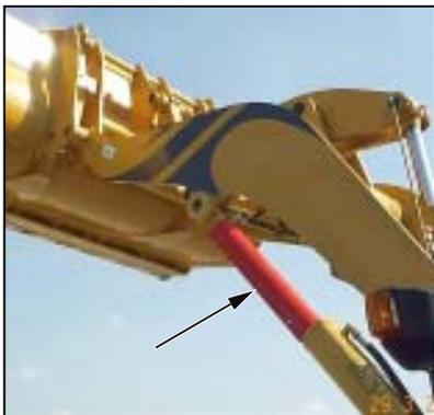
Sicherungsstange beim Betrieb
