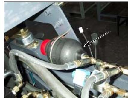
Die Bremsanlage sieht einen speziellen Energiespeicher vor, der dazu dient, auch bei abgestelltem Motor mit der Servobremse bremsen zu können.
