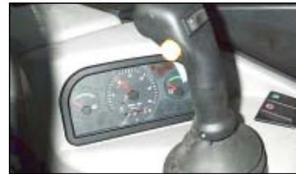
Der Stundenzähler ermöglicht es, den Wartungszeitpunkt zu erkennen. Wenn der (Wärme-)Motor angestellt ist, zeigt er die normale Uhrzeit an.
