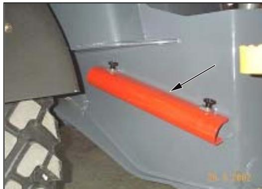
Sicherungsstange in Restposition
