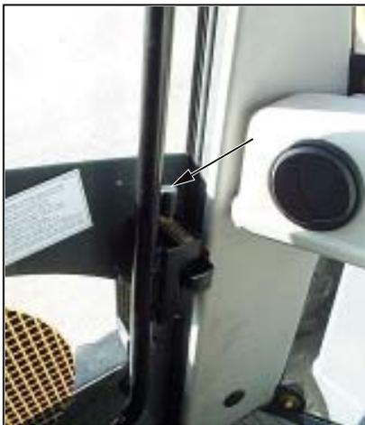
Zur Öffnung der Nottür (rechts) von innen den abgebildeten Griff nach oben drehen.
