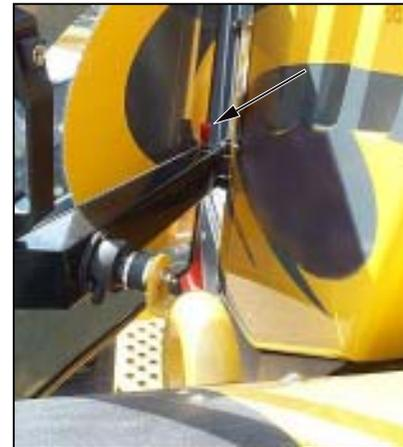
Um die Blockierung der Nottür (rechts) in der offenen Position zu lösen, den abgebildeten Kugelgriff entgegen dem Uhrzeigersinn drehen.
