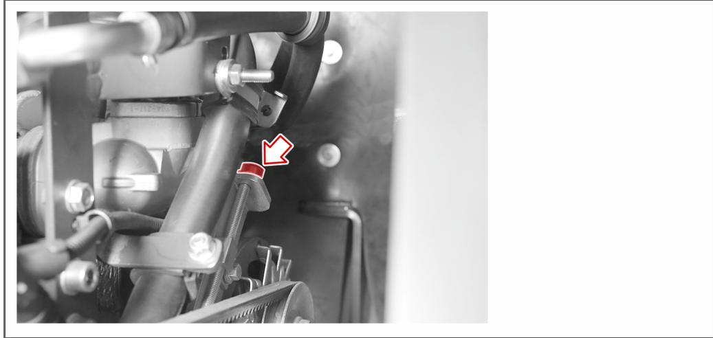
Emplacement de la vis de serrage de la courroie - Vue compartiment moteur
