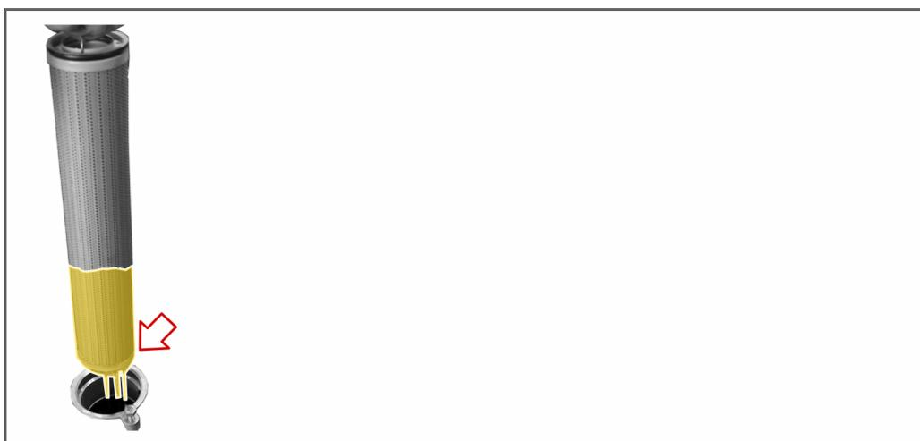
**5.** Déposez le filtre à huile hydraulique dans le réservoir collecteur d'huile.
