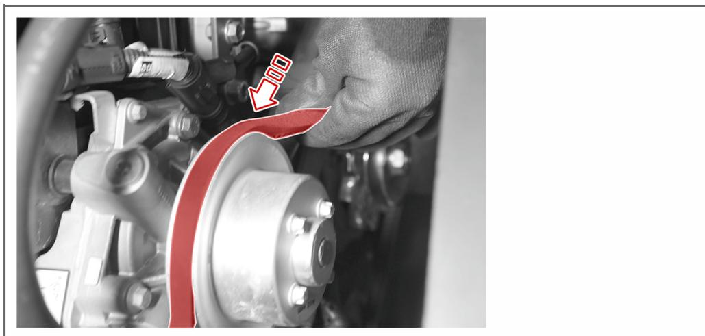
2. Serrer la courroie trapézoïdale avec la vis de serrage de la courroie trapézoïdale.
