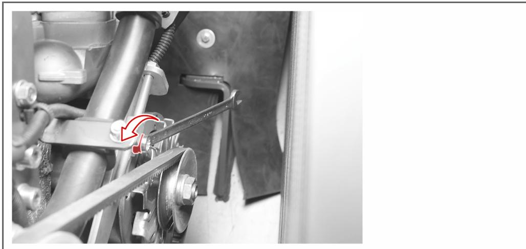
3. Desserrez la vis de fixation à l'aide d'une clé plate.
