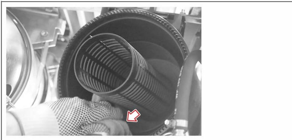
3. Schieben Sie die neue Sicherheitspatrone vorsichtig in das Filtergehäuse.
