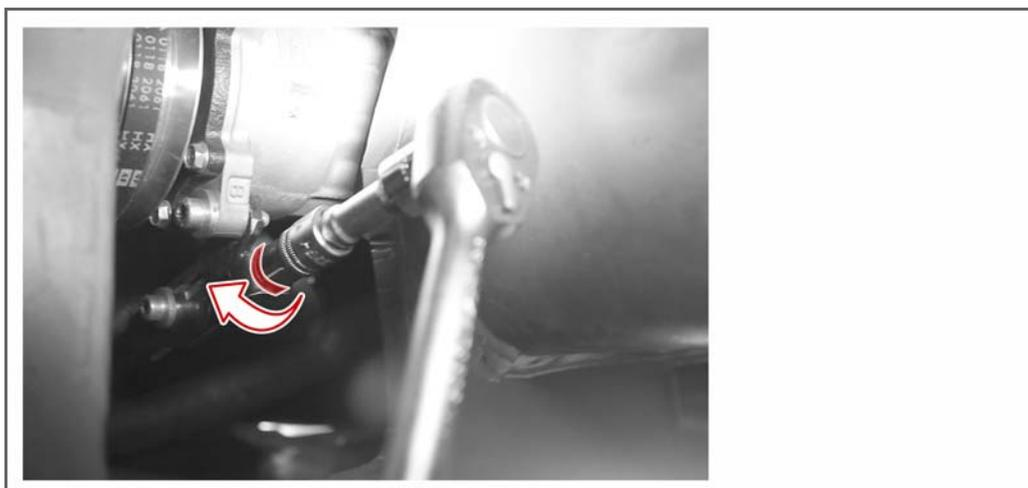
4. Ziehen Sie mit einem Innensechskantschlüssel die Befestigungsschraube fest.
