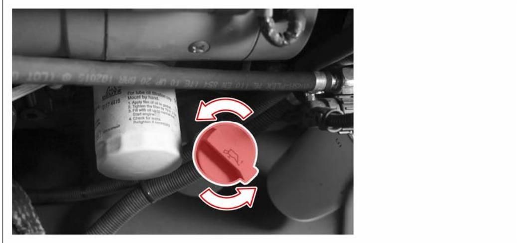
2. Füllen Sie mit einem geeigneten Trichter das Motoröl in den geöffneten Motoröl-Einfüllstutzen.
