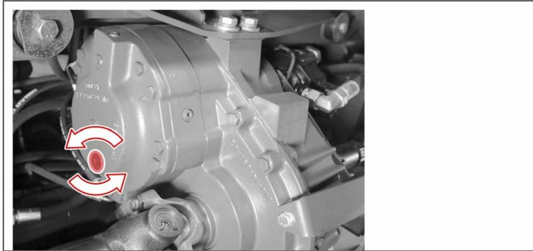
3. Drehen Sie mit einem Innensechskantschlüssel die Ablassschraube heraus.
