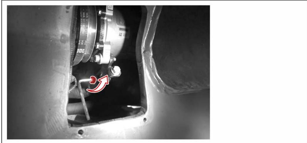
3. Lösen Sie mit einer Knarre die Riemen-Spannschraube.
