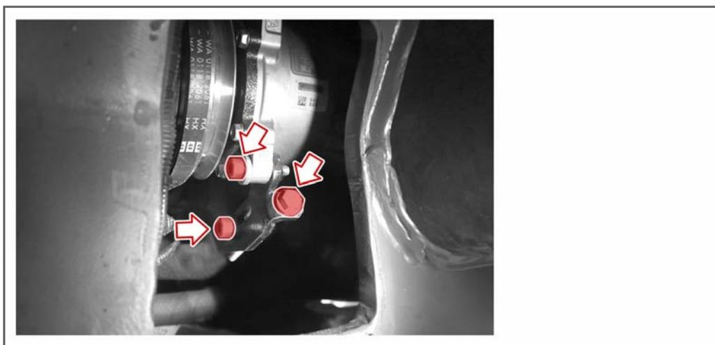
Lage der Befestigungs- und Spannschrauben – Ansicht Montageabdeckung
