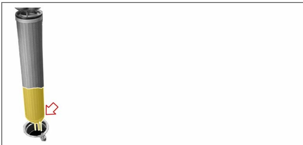
5. Legen Sie den Hydrauliköl-Filter in den Öl-Auffangbehälter.
