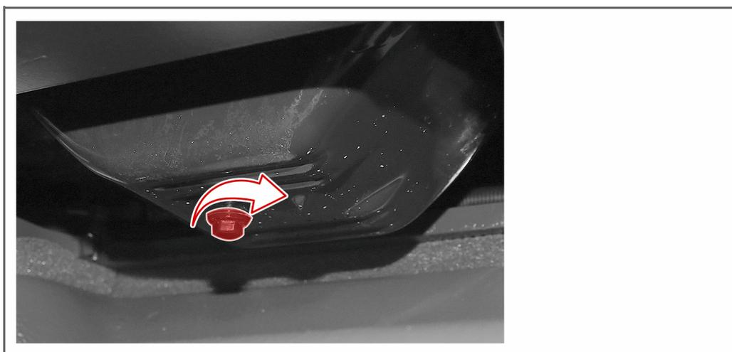
5. Reinigen Sie mit dem Lappen eventuell mit Öl verschmutzte Stellen an der «ÖLWANNE»
