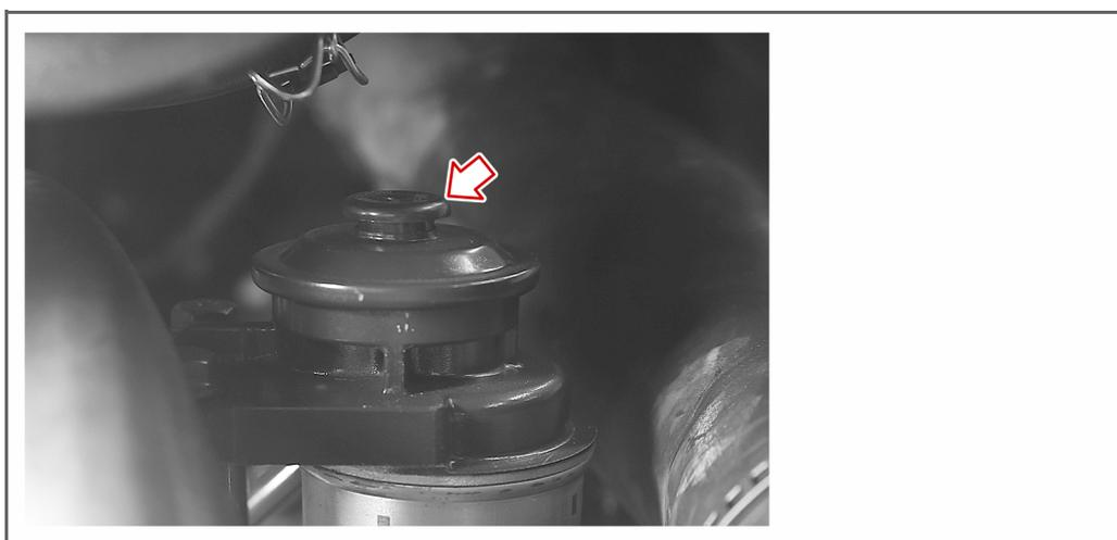
↪ Der neue Filtereinsatz wird mit Diesekraftstoff befüllt.
