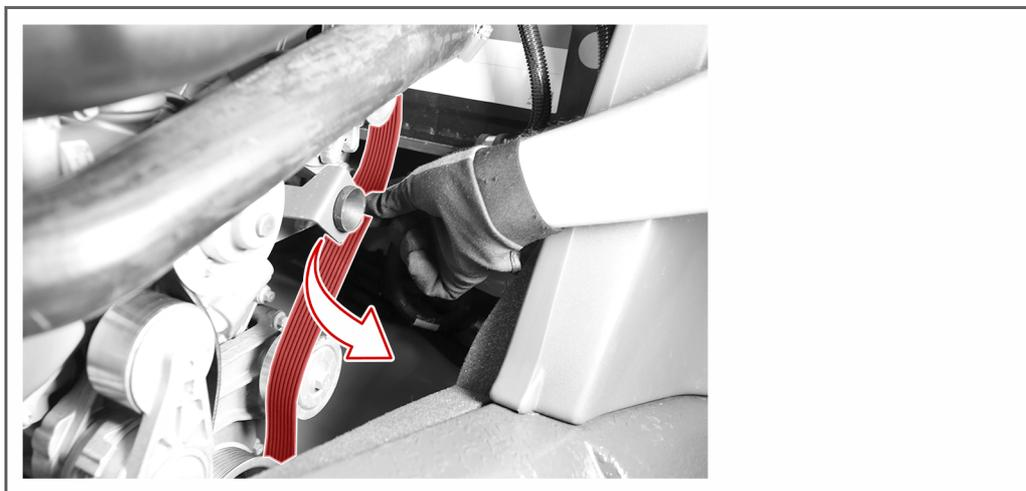
5. Montieren Sie den neuen «KEILRIEMEN».
