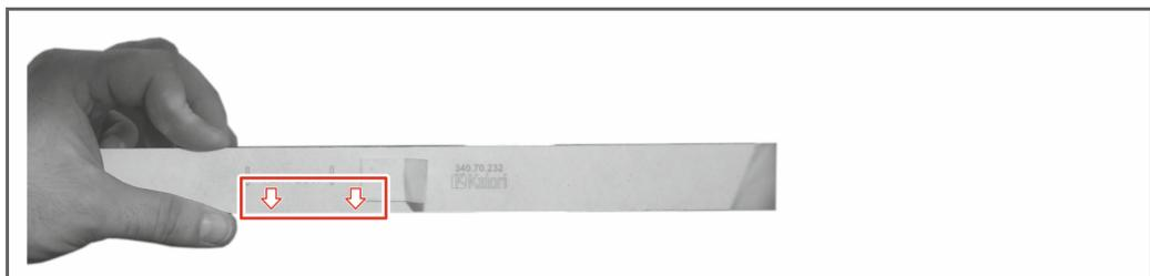
6. Legen Sie die Abdeckung des «FRISCHLUFTFILTERS» auf die Öffnung.
