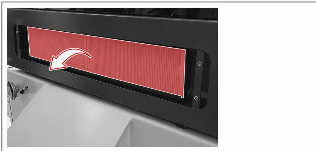
5. Schieben Sie die neuen «FRISCHLUFTFILTER» in die Halterung.
