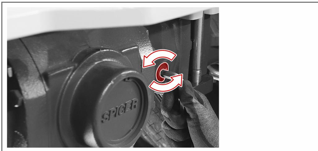
2. Füllen Sie neues Getriebeöl bis zur Unterkante beider Kontrollöffnungen auf.
