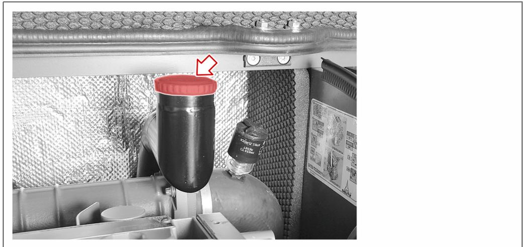
2. Füllen Sie mit einem geeigneten **«TRICHTER»** das **«HYDRAULIKÖL»** in den geöffneten **«HYDRAULIKÖL-EINFÜLLSTUTZEN»**.
