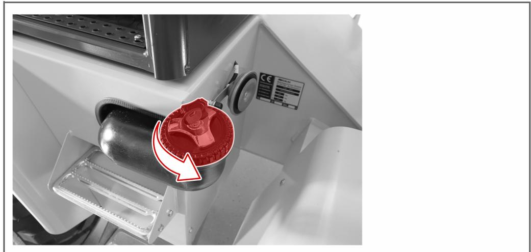
2. Verwenden Sie einen Diesekraftstoff-Auffangbehälter mit ausreichender Kapazität
