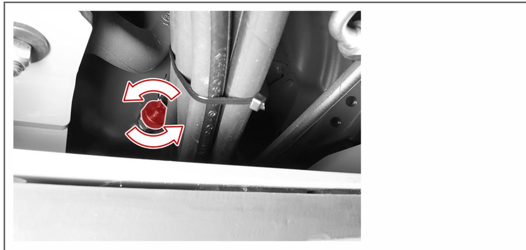
3. Schrauben Sie den Bohrerstopfen auf den Öl-Ablasstopfen.
