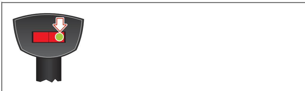
↳ Der Radlader wird bei Stillstand nach **vier Sekunden** in die gewünschte Getriebestufe umgeschaltet.
