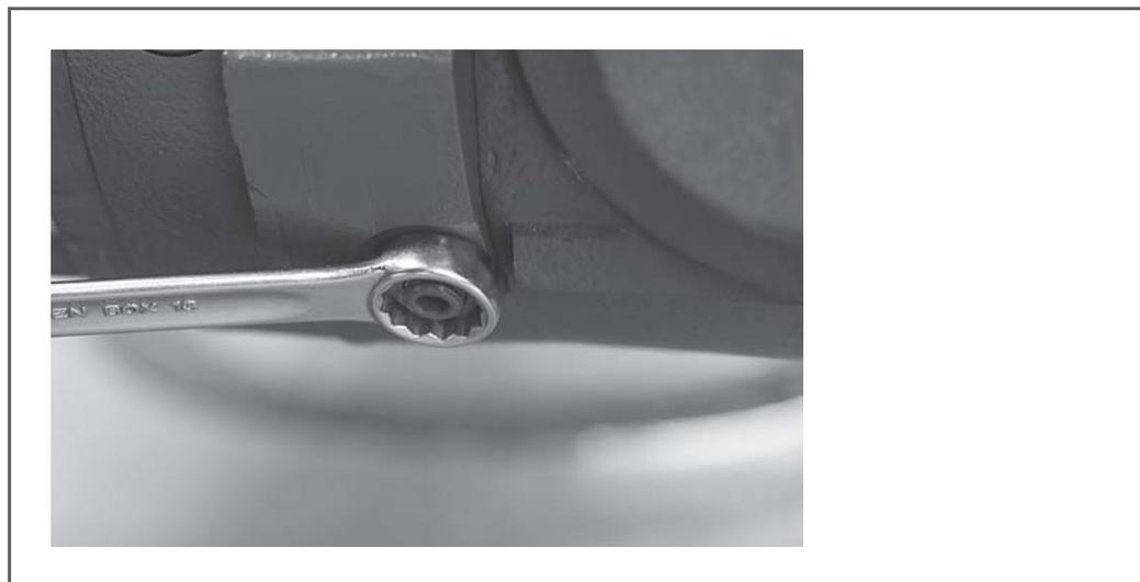
↳ Die Anschlagsschraube ist gegen Lösen gesichert.
