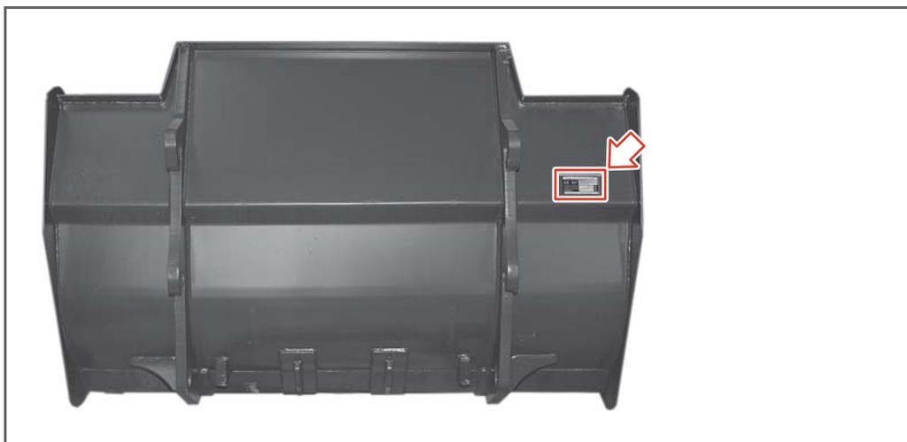
Lage des Typenschildes am Anbaugerät (Rückseite)
