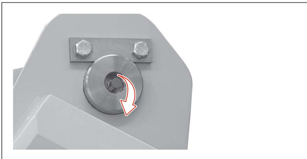
3. Reinigen Sie den «SCHMIERNIPPEL» mit dem «LAPPEN».
