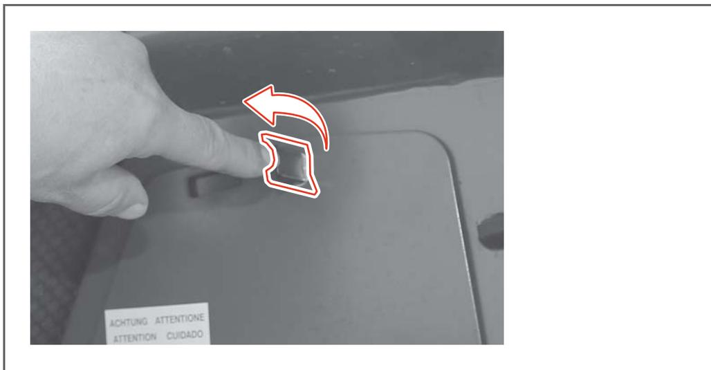
3. Hängen Sie die **MOTORRAUMABDECKUNG – LINKS** an den Befestigungs- und Führungspunkten ein.
