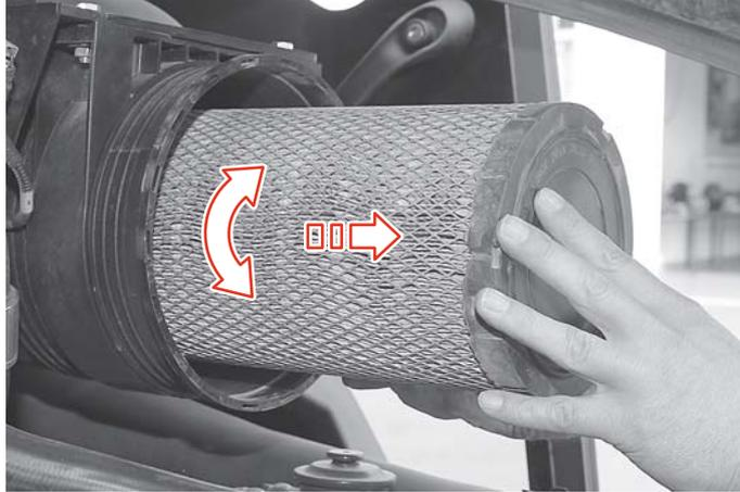
Die Luftfilterpatrone wurde demontiert.
