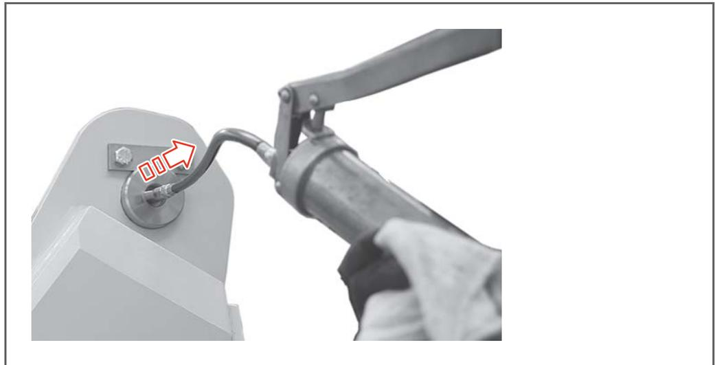
2. Reinigen Sie den ‹SCHMIERNIPPEL› mit dem ‹LAPPEN›.
