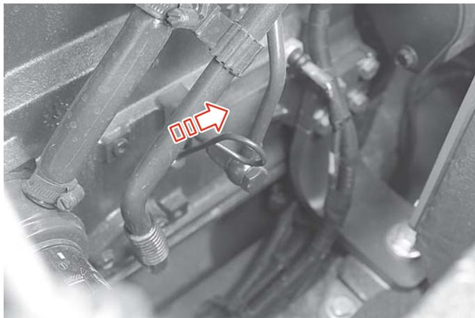
2. Reinigen Sie den «ÖLMESSTAB» mit dem «LAPPEN».
